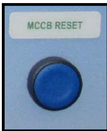
Рисунок 7-6. Кнопка перезагрузки MCCB (-S11)
