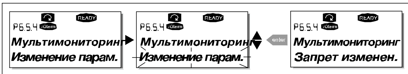
Рисунок 9-17. Разрешение на замену трех контролируемых параметров
