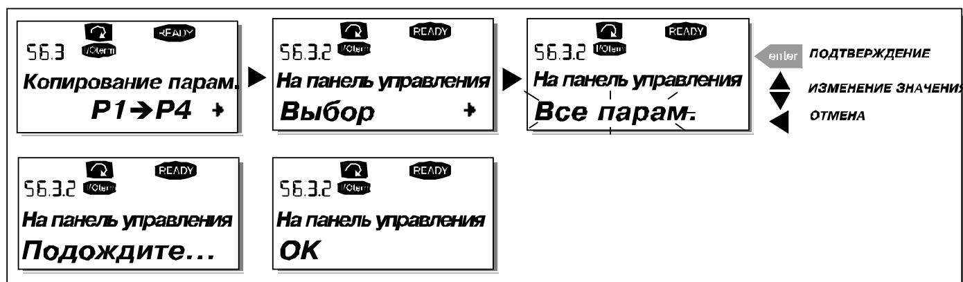
Рисунок 9-12. Копирование параметров в панель управления
